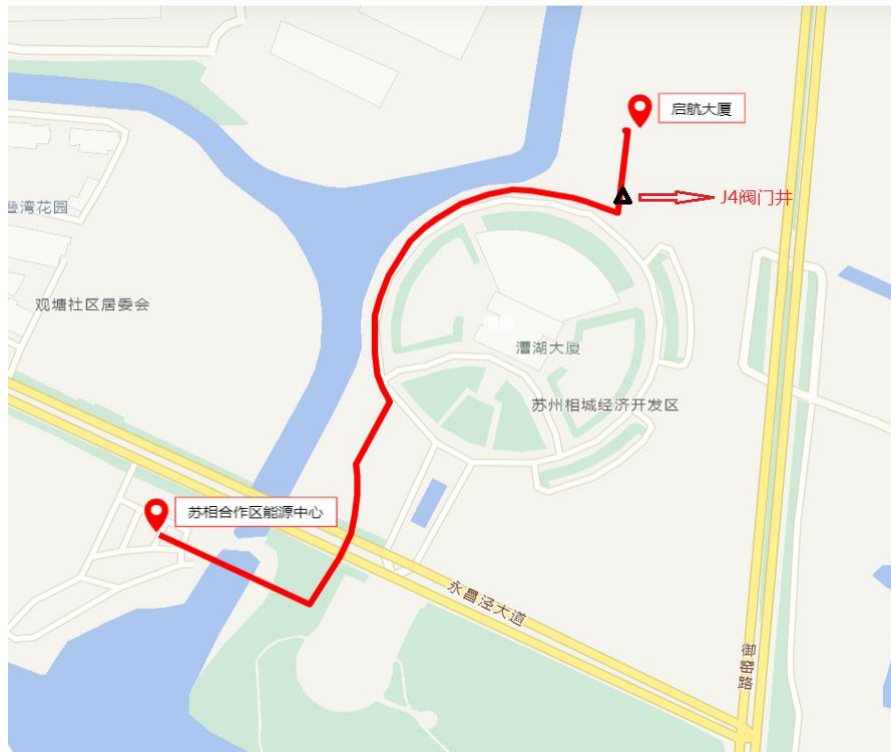
图3 启航时代大厦管线走向
